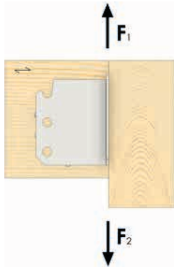
Anschluss Holz/Holz Teil- und Vollausnagelung bzw. Teil- und Vollausschraubung
